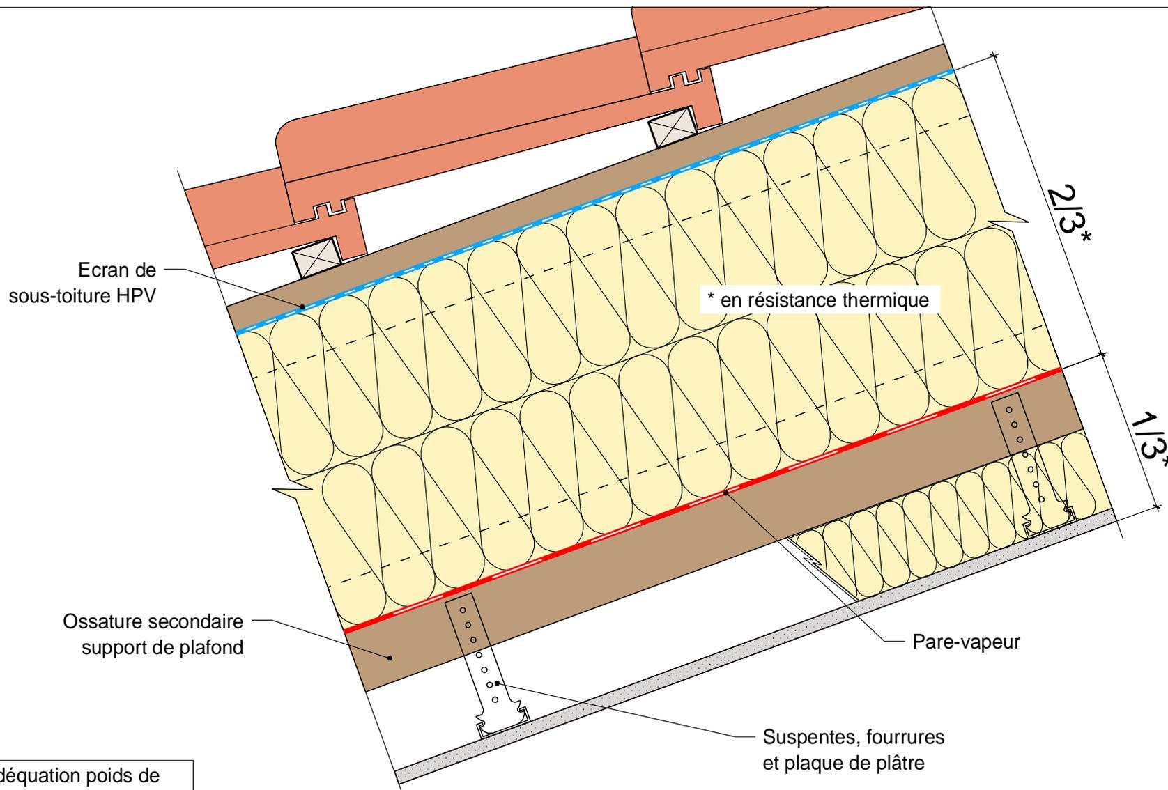
NOTA: Adéquation poids de l'isolant et résistance à la déchirure au clou du pare-vapeur à maîtriser
