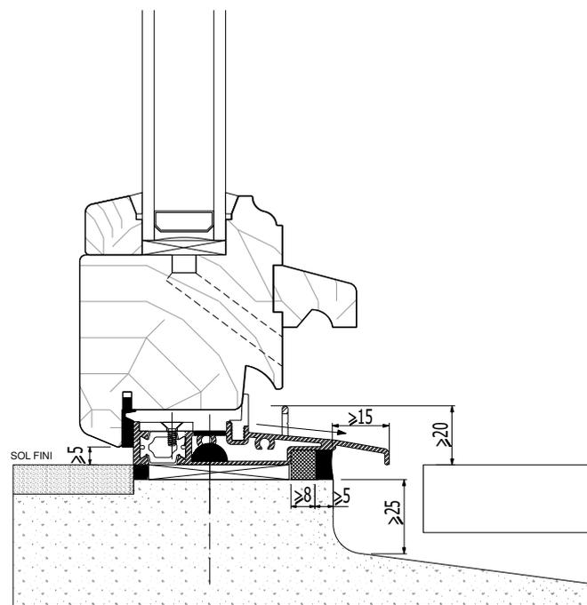
Joint central sur ouvrant et Joint en recouvrement intérieur
