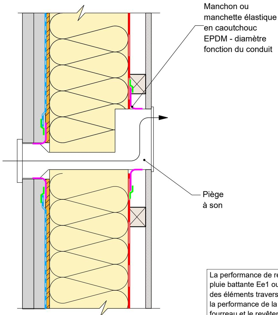
La performance de résistance à la pluie battante Ee1 ou Ee2 au droit des éléments traversants dépend de la performance de la liaison entre le fourreau et le revêtement extérieur. Si cette liaison est étanche à l'eau, le point singulier est de niveau Ee2 (Cf. référentiel dont relève le revêtement extérieur).
